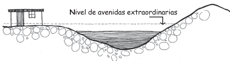
En zonas inundables por crecidas de ríos.
